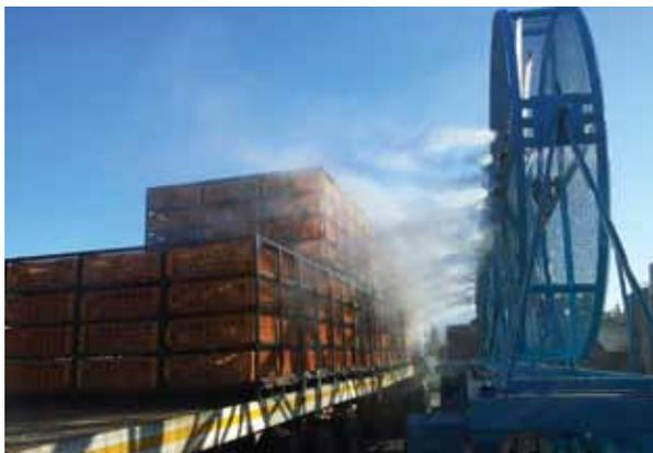
Tráiler (remolque) con ventilador para el enfriamiento en granja cuando se carga
