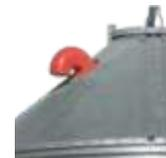
Sistema con respiradero en el techo para evitar el incremento de humedad dentro del silo.
