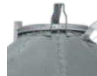
Sistema de apertura de la tapa mediante de una palanca bajo tensión y cadena.
