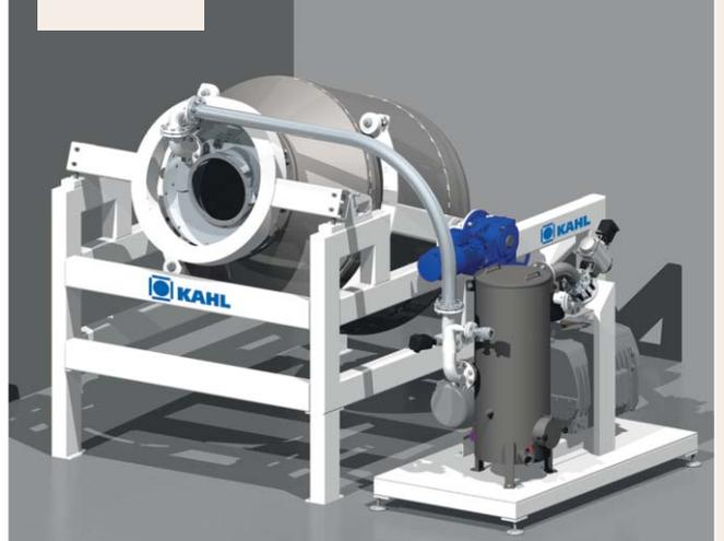
En la posición de trabajo, el vacío se genera y luego uno o más líquidos se pulverizan uno tras otro sobre el producto. (No se muestran las boquillas y la adición de líquido.) El vacío se rompe de forma definida.
