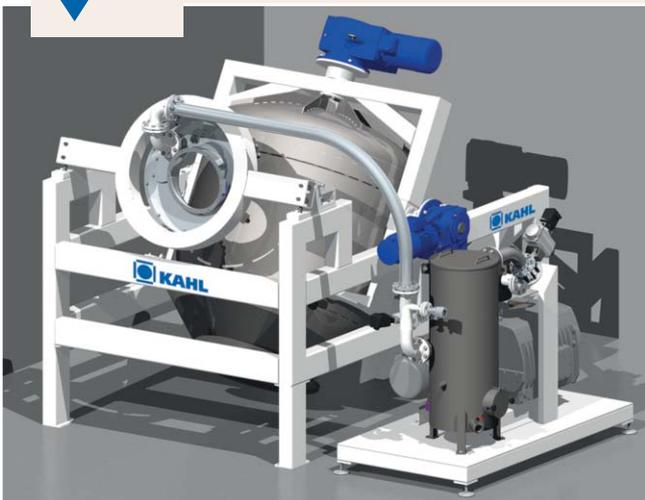
El vaciado del tambor se lleva a cabo por un movimiento oscilante hacia abajo. El tambor continúa girando mientras tanto. Un vaciado completo está garantizado.
