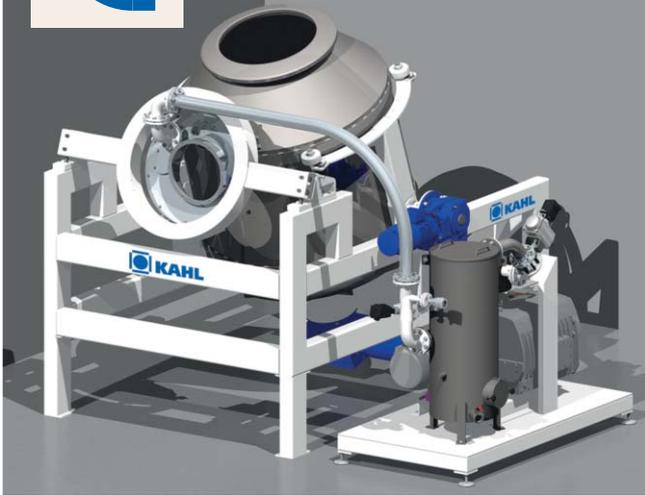
El tambor se llena con el material a procesar. El pesaje y la dosificación se hacen por las células de carga de alta precisión integradas en el recubridor al vacío.. El tambor oscila en la posición de trabajo y gira.
