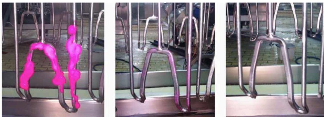
**FIGURA 2:** La aplicación y posterior aclarado del producto TBF 300 en una superficie de un gancho de colgado tras la limpieza y desinfección (izquierda) revela la presencia de biofilms por medio de una coloración permanente y detectable a simple vista tras el aclarado (centro). Después del fregado manual con un detergente específico para la limpieza de biofilms, se volvió a aplicar la espuma TBF 300 sin aparecer coloración residual (derecha), indicando la eliminación de biofilm.
