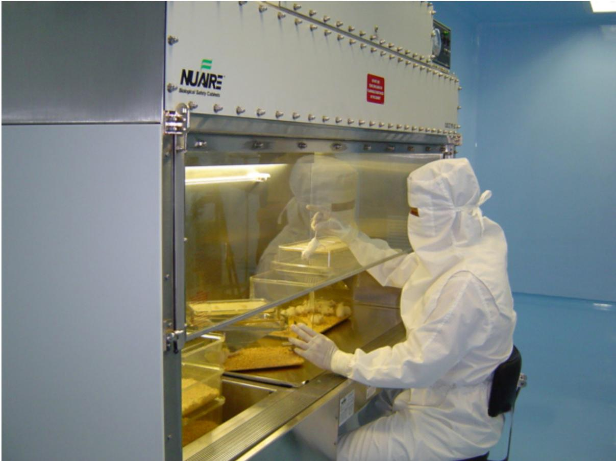
**Figura 5.** Estaciones de cambio que funcionan como campana de flujo laminar para realizar el cambio de los animales y que estos no se contaminen (foto: Heuze, UAM-X).
