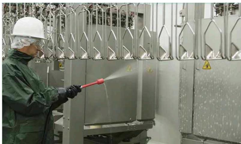
**FIGURA 2.** Desinfección de la sala de eviscerado de un matadero de aves mediante un sistema de pulverización.
