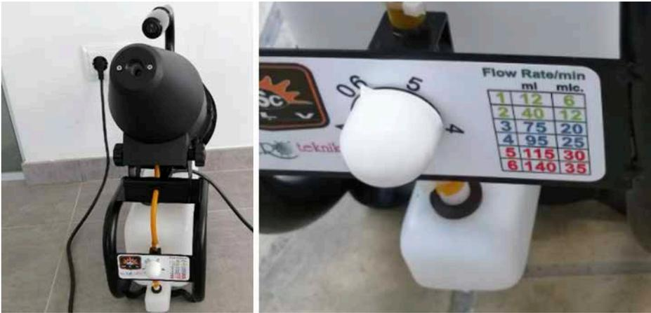
**FIGURAS 5 Y 6.** Equipo de nebulización H05 ULV FOGGER, y detalle de la regulación de caudal y tamaño de partícula.
