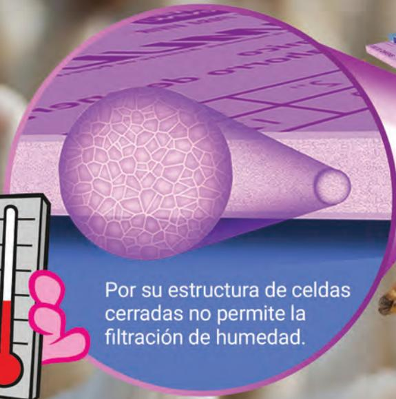
Por su estructura de celdas cerradas no permite la filtración de humedad.
