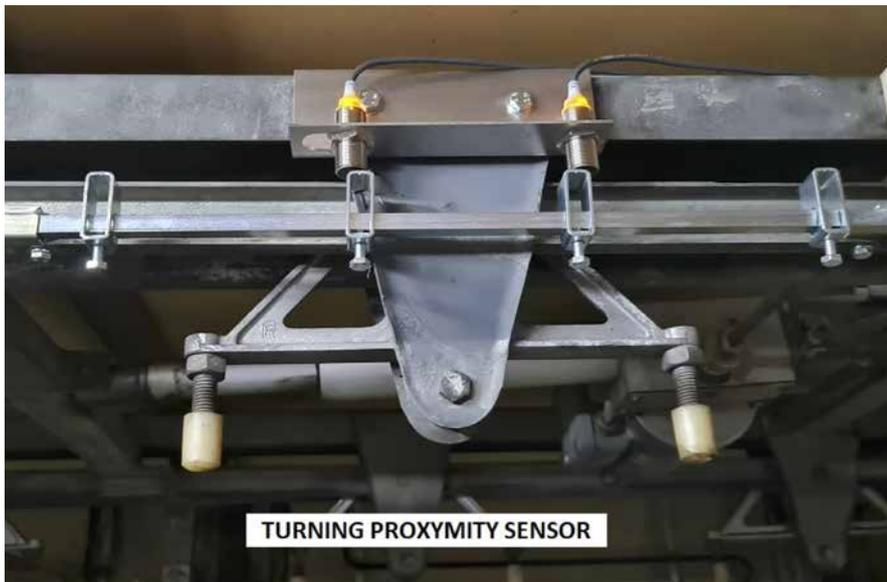
Foto 4. Mecanismo de volteo con sensores de proximidad para determinar el ángulo correcto en ambas posiciones.
