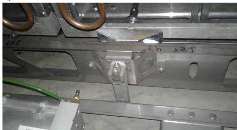
Foto 6. Opción de volteo con andamiaje de piso y pistón neumático en una incubadora de carga única.
