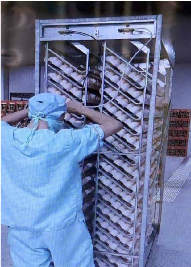
Foto 8. Constatar el funcionamiento correcto del volteo en cada coche antes de re-introducirlos en la máquina incubadora.
