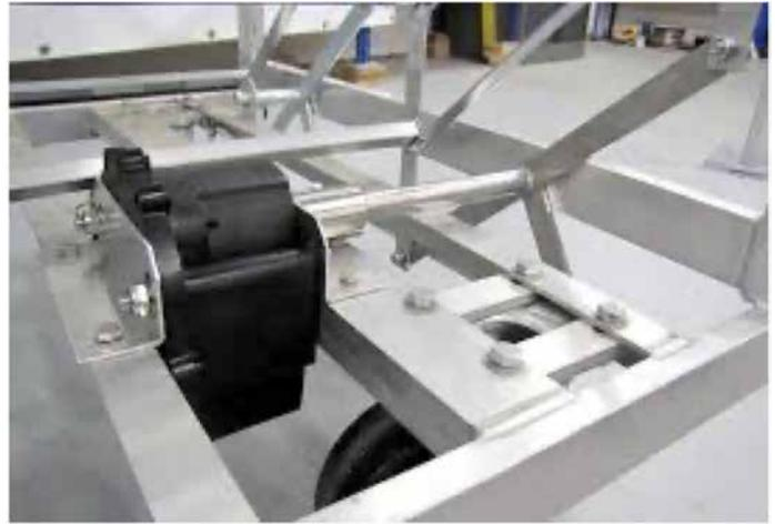
Foto 7. Opción de motor eléctrico de volteo en cada carro de la incubadora.
