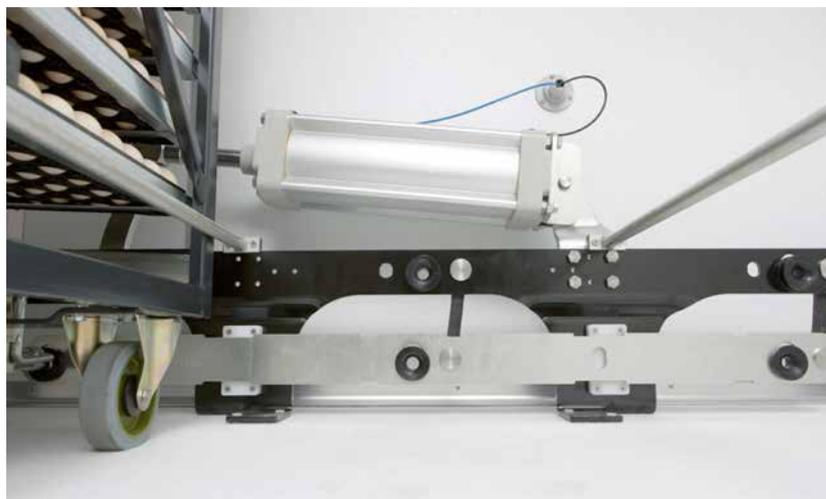
Foto 5. Pistón neumático de volteo ubicado en la parte posterior del gabinete de la incubadora.
