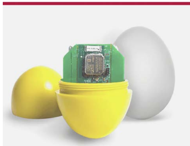
FIGURA 2: Huevo artificial con sensor de fuerza G incorporado (cracklessegg.com).
